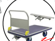
NGS-401-6 พื้นเหล็กขนาดใหญ่ มือจับพับได้ มีเบรก ล้อ6นิ้ว ขนาด : ก79xย124 ซม. มือจับสูง 83 ซม.
