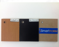
แผ่น TOP ตู้เก็บเอกสารสูง ใช้ไม้หนา 25 mm. เพื่อเพิ่มความแข็งแรง และปิดผิวด้วยลามิเนตทั้ง 2 ด้าน
